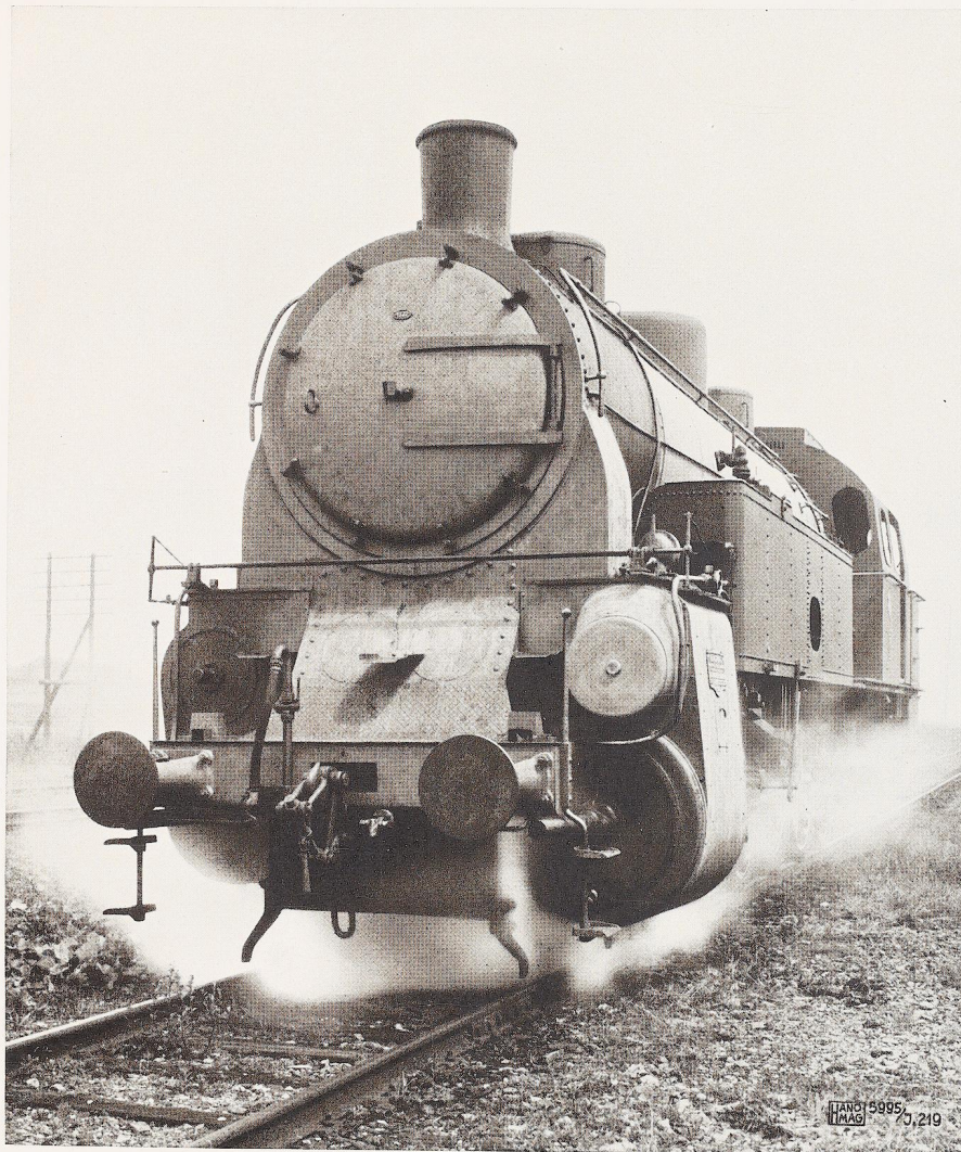
Bild 23. Die 10 000. Hanomag-Lokomotive (Bild 24) auf der Probefahrt. Beachtenswert sind die Abmessungen des größten bis jetzt angewandten Niederdruckzylinders von 900 mm Durchmesser. Druckstock: Hanomag, Hannover-Linden.
