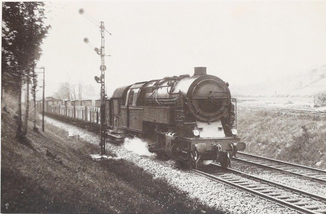
Bild 59. 1 E 1-Zweizylinder-Heißdampf-Güterzug-Tenderlokomotive Gattung T 20 (Bild 58) mit schwerem Güterzug auf Steigung 1 : 70 in Thüringen. Druckstock: Hanomag, Hannover-Linden.
