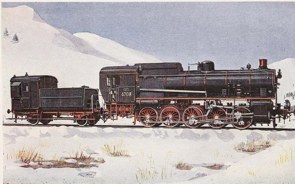
Bild XIX. E-Vierzylinder-Verbund-Gebirgslokomotive der Italienischen Staatsbahnen. Erbaut von J. A. Maffei, München. Farbplatten: J. A. Maffei, München.
