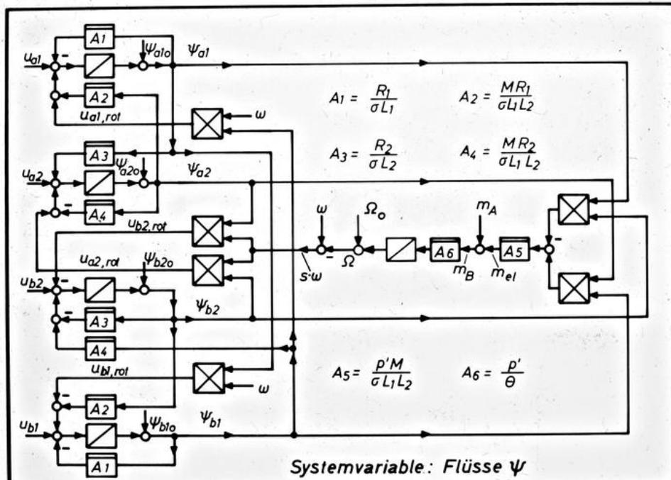
**EW** Strukturbild der transformierten Asynchronmaschine im drehfeldbezogenen a,b-System
