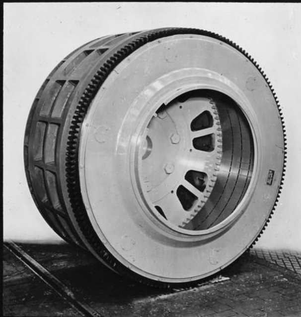
AEG Außen- und Innenteil einer Schlupfkupplung, normales Drehmoment 3600 mkg bei 250 U/min TV 56 3404
