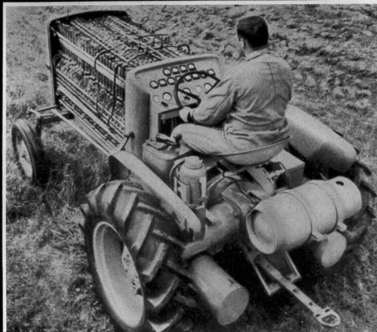
Bild 12. Ansicht des elektrochemisch angetriebenen Traktors der Allis-Chalmers Mfg. Co. Unter dem Führersitz befindet sich das Stahlfaß mit dem Brenngas H_2 + C_3H_8 , unter dem Fahrzeug Druckflaschen mit O_2 . Kraftregelung und Rückwärtsgang durch Controller. Höchstleistung 15 kW.
