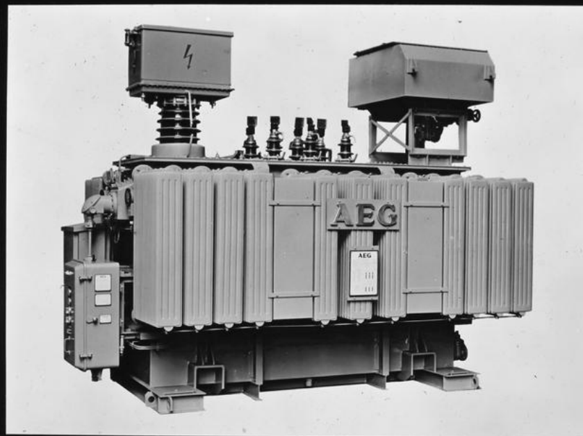
AEG 10/12,5 MVA-Drehstrom-Öltransformator 10 ± 1,35/5,25 kV mit neuen Radiatoren, horizontaler Beblasung u. geräuscharmer Lüfterschachtabdeckung TV 56 3395
