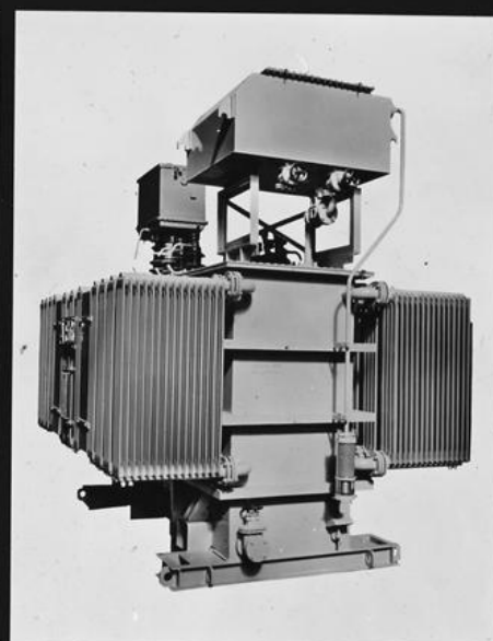
AEG 10/12,5 MVA-Drehstrom-Öltransformator 10 ± 1,35/5,25 kV mit neuen Radiatoren, horizontaler Beblasung u. geräuscharmer Lüfterschachtabdeckung TV 56 3396
